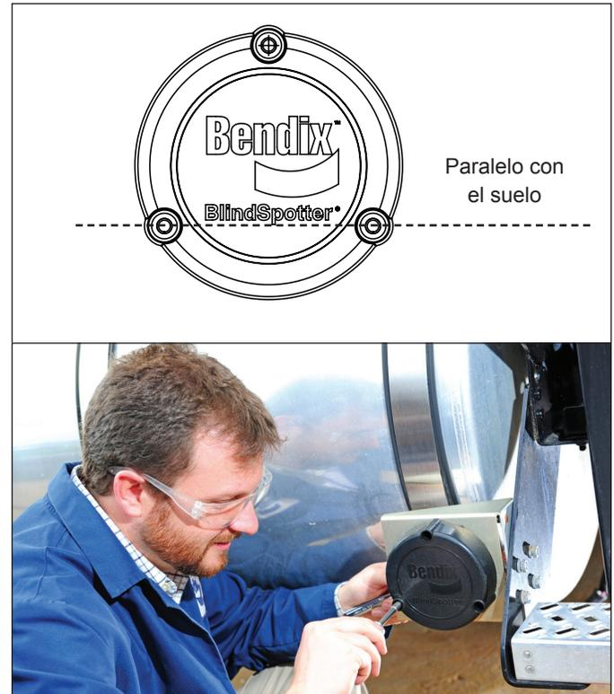
FIGURA 5 – INSTALACIÓN DEL SENSOR
